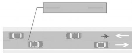
**RAYA SEPARADORA DE SENTIDOS DE CIRCULACIÓN DISCONTINUA SENCILLA:** Indica a los usuarios la separación de los sentidos de circulación vehicular, en vías en las que se permite el rebase utilizando el carril en sentido contrario.
