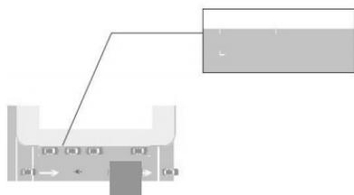
**ESTACIONAMIENTO EN ZONAS DE PARQUÍMETROS:** Indica a los usuarios la presencia de espacios para estacionamiento, en zonas con cobro en vía pública. El usuario debe hacer uso de un solo cajón para estacionar su vehículo.
