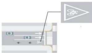
**IDENTIFICACIÓN DE VÍA CON PRIORIDAD DE USO:** Indica a los usuarios que están circulando por una vía, en la que un tipo de vehículo tiene derecho en su utilización sobre los demás.
