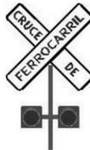
**SEMÁFORO PARA CRUCES CON VÍAS FÉRREAS:** Previene a los conductores de vehículos de la aproximación de un cruce a nivel con una vía férrea.
