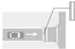
**RAYA DE ALTO:** Indica a los conductores de vehículos el lugar en el que deben detenerse debido a una señal de alto, semáforo o punto de control en el camino.
