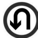
**VUELTA EN «U»:** Indica a los conductores de vehículos que el movimiento de vuelta en «U» se debe realizar a través del carril de desaceleración del costado derecho o izquierdo de la vía.
