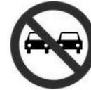
**PROHIBIDO REBASAR:** Indica a los conductores de vehículos los tramos en los que no se permite adelantar a otro, por condiciones especiales como visibilidad o el ancho de la vía, entre otras. El pictograma indica el tipo de vehículo al cual se restringe realizar esta acción.
