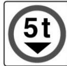
**PESO PERMITIDO:** Indica a los conductores de vehículos la restricción de peso, ya sea por la capacidad de la superficie de rodadura o alguna estructura.
