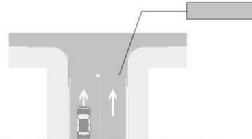
**RAYA DE CEDA EL PASO:** Indica a los conductores de vehículos el lugar en el que deben detenerse debido a una señal de ceda el paso.
