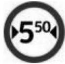
**ANCHO PERMITIDO:** Indica a los conductores el ancho libre de un elemento o estructura que limita el tránsito de vehículos de grandes dimensiones, o que impide el paso simultáneo de dos.
