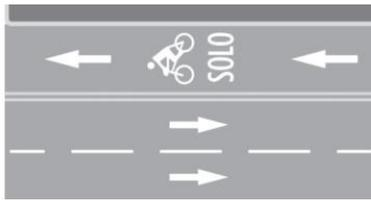
**IDENTIFICACIÓN DE VÍA CICLISTA EXCLUSIVA:** Indica a los usuarios la existencia de un ciclocarril, ciclovia unidireccional o ciclovia de trazo independiente.
