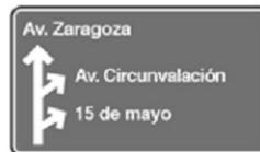
**DIAGRAMÁTICA:** Indica a los conductores de vehículos, mediante un esquema, los puntos de decisión en una intersección.
