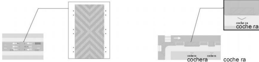
**IDENTIFICACIÓN DE REDUCTORES DE VELOCIDAD:** Indica a los conductores de vehículos la presencia de un dispositivo para control de velocidad.
