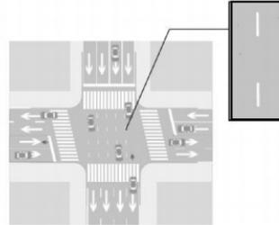
**RAYA GUÍA EN INTERSECCIÓN:** Indica a los conductores de vehículos la trayectoria que deben seguir, en intersecciones que, por su diseño o condiciones de visibilidad, no son predecibles.
